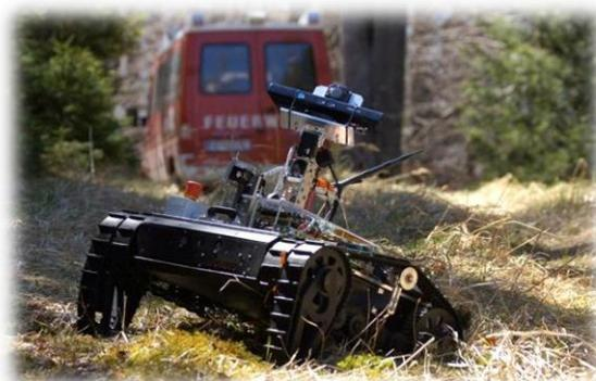
Zum Einsatz kamen unbemannte Drohnen, die in Kärnten entwickelt wurden und ein Roboter der TU-Graz. Feuerwehr-Roboter „Zaphod“ spürte mit Infrarotsensoren und Wärmebildkamera Brandherde im Wald auf.
