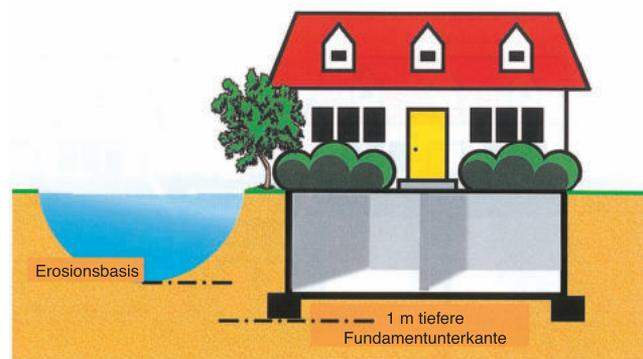
Falsche Bauausführung kann zu Erosion und somit zur Unterspülung der Fundamente führen. Durch den Austrag von Bodenteilchen aus dem Bodengefüge kann es zu Hohlräumen im Baugrund kommen, die Gebäudeschäden infolge von Setzungen verursachen.
